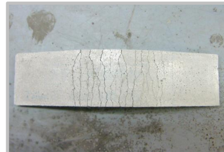
曲げに対して追従（割れない&ひび割れの分散）
